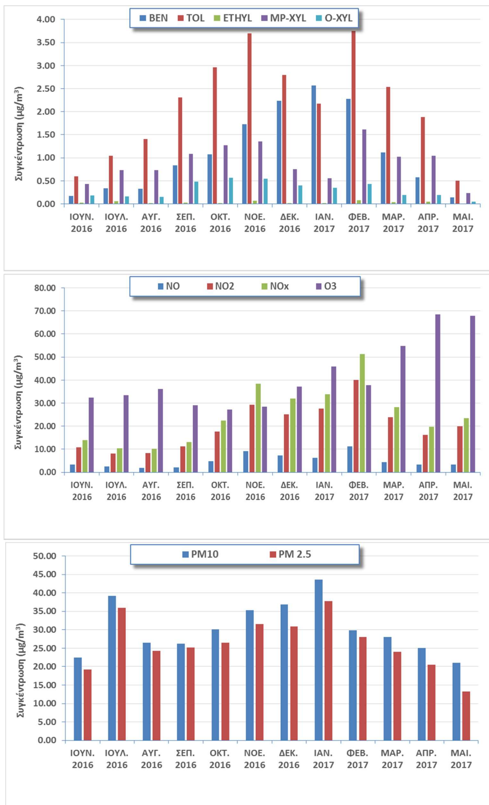
Σχήμα 2.1.3. Μέση μηνιαία διακύμανση των συγκεντρώσεων BTEX, NOx, O 3 , PM 10 και PM 2.5 κατά το χρονικό διάστημα 02/06/2016 – 01/06/2017
