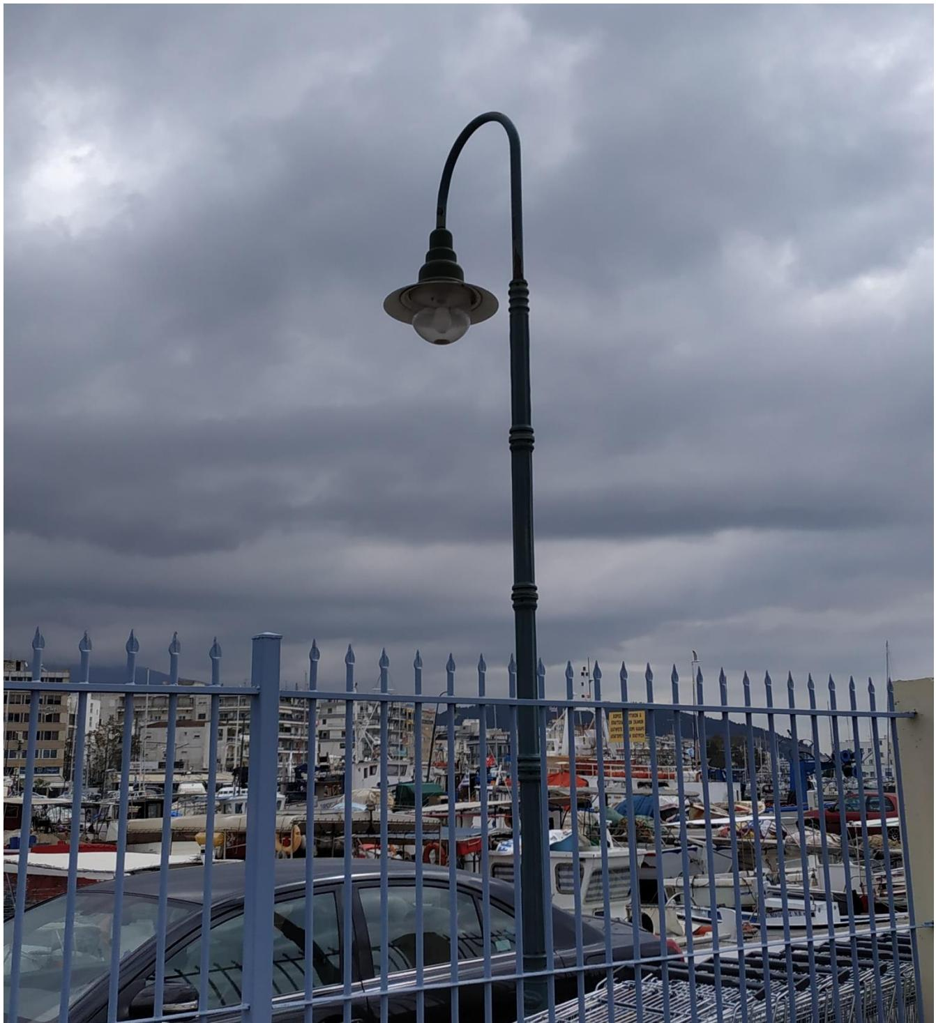
3. Μεταλλικός ιστός (φωτιστικό δρόμου), ύψους 9 μέτρων με λαμπτήρα 250W
